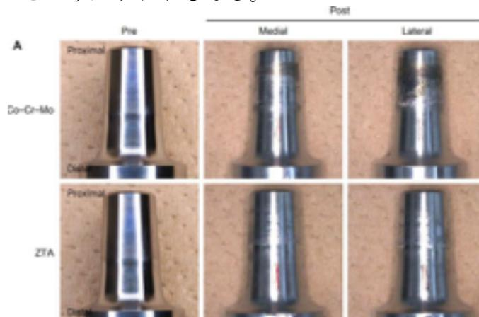
Fig. 2 Hip Simulator試験実施後のテーパの腐食状態の比較写真
